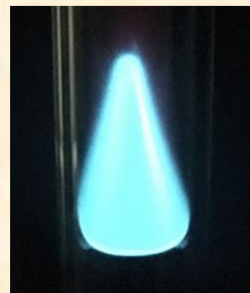
变径管内稳定 预混火焰
